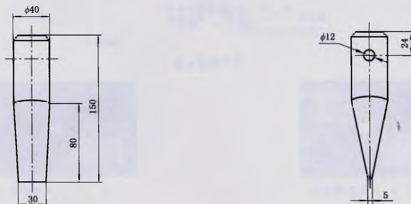
图 6 冲击工具侧截面示意图
