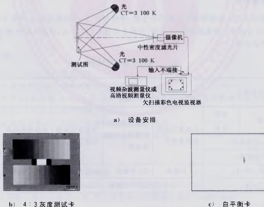
图 8 亮度信号信噪比检验的设备安排及测试图
